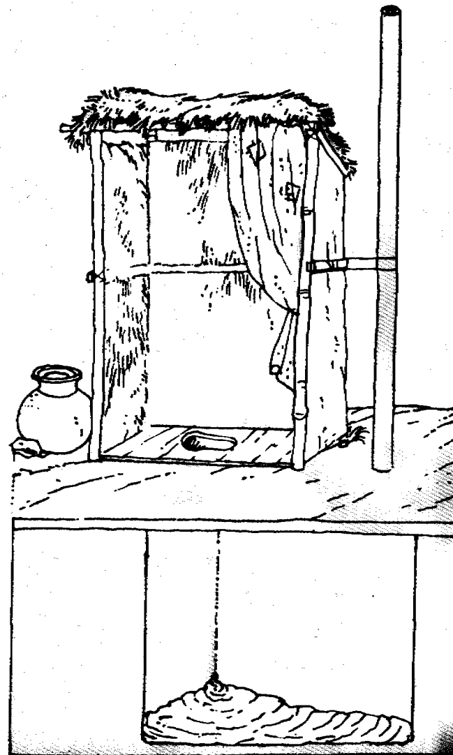
Fig. 5.5. a VIP latrine
