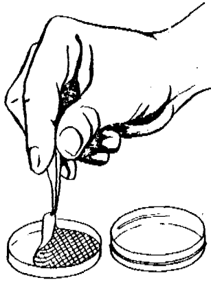
Fig. 12. Mise en place de la membrane sur le tampon imbibé de milieu de culture.
