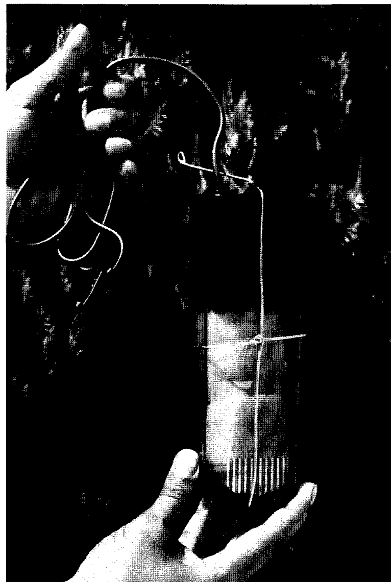
Colector eléctrico de S.S.a.
