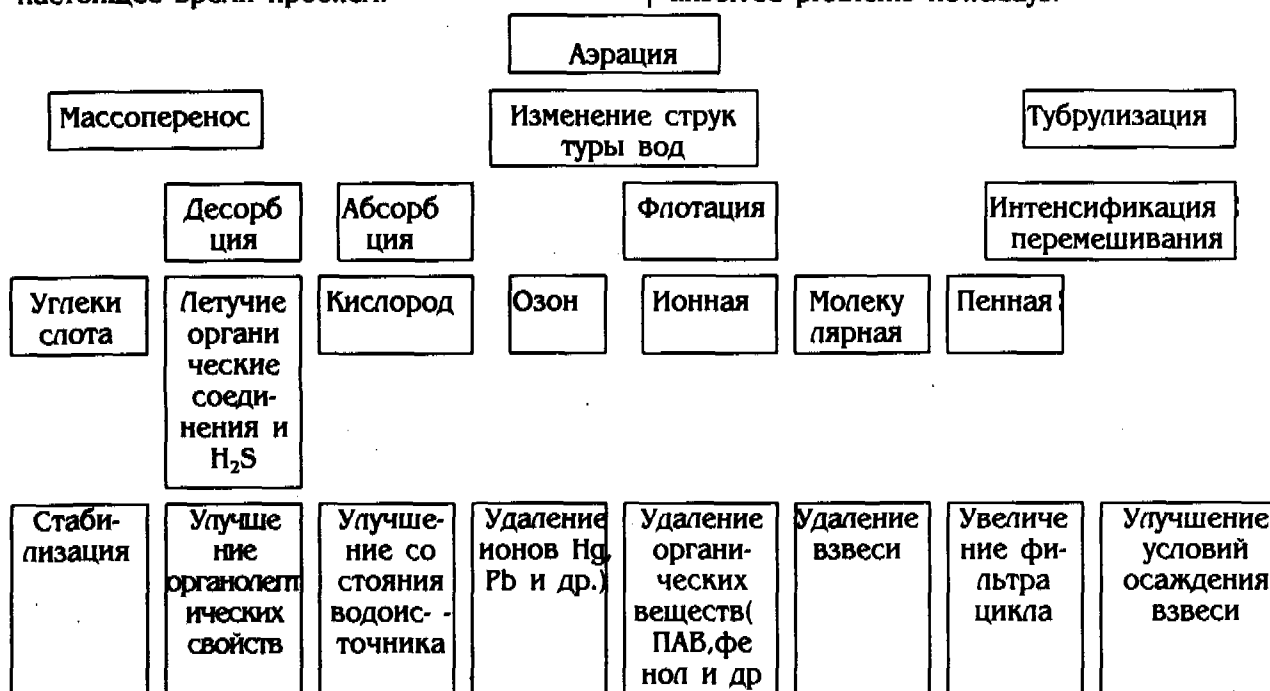
РИС.1 Схема влияния аэрации на процессы очистки воды
