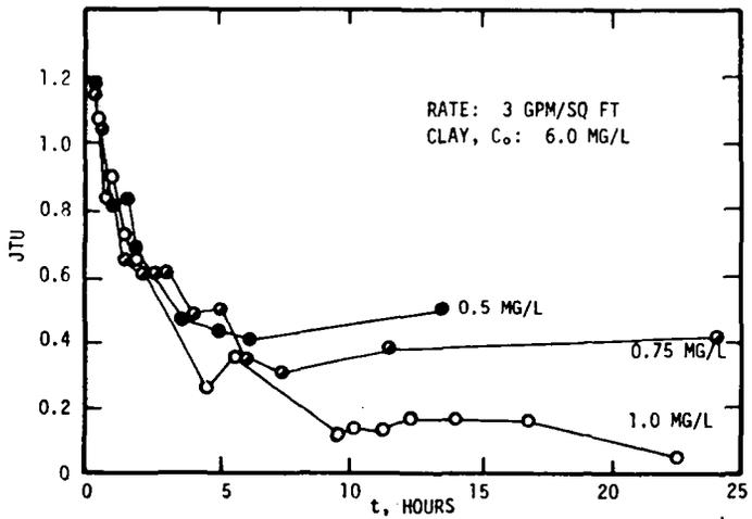
FIG 9. EFFECT OF CATFLOC ON FILTER PERFORMANCE\*
