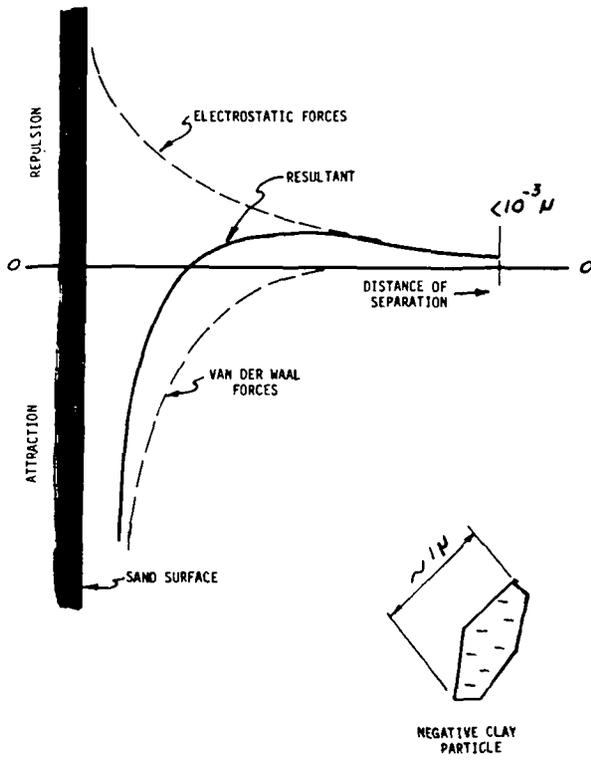
FIG 5B. ELECTROSTATIC FORCES
