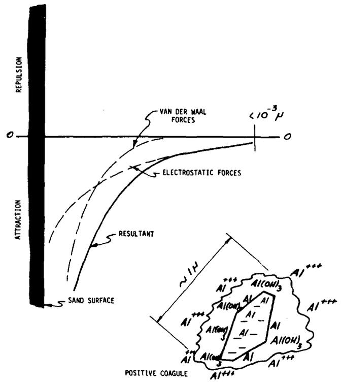
FIG 5C. ELECTROSTATIC FORCES
