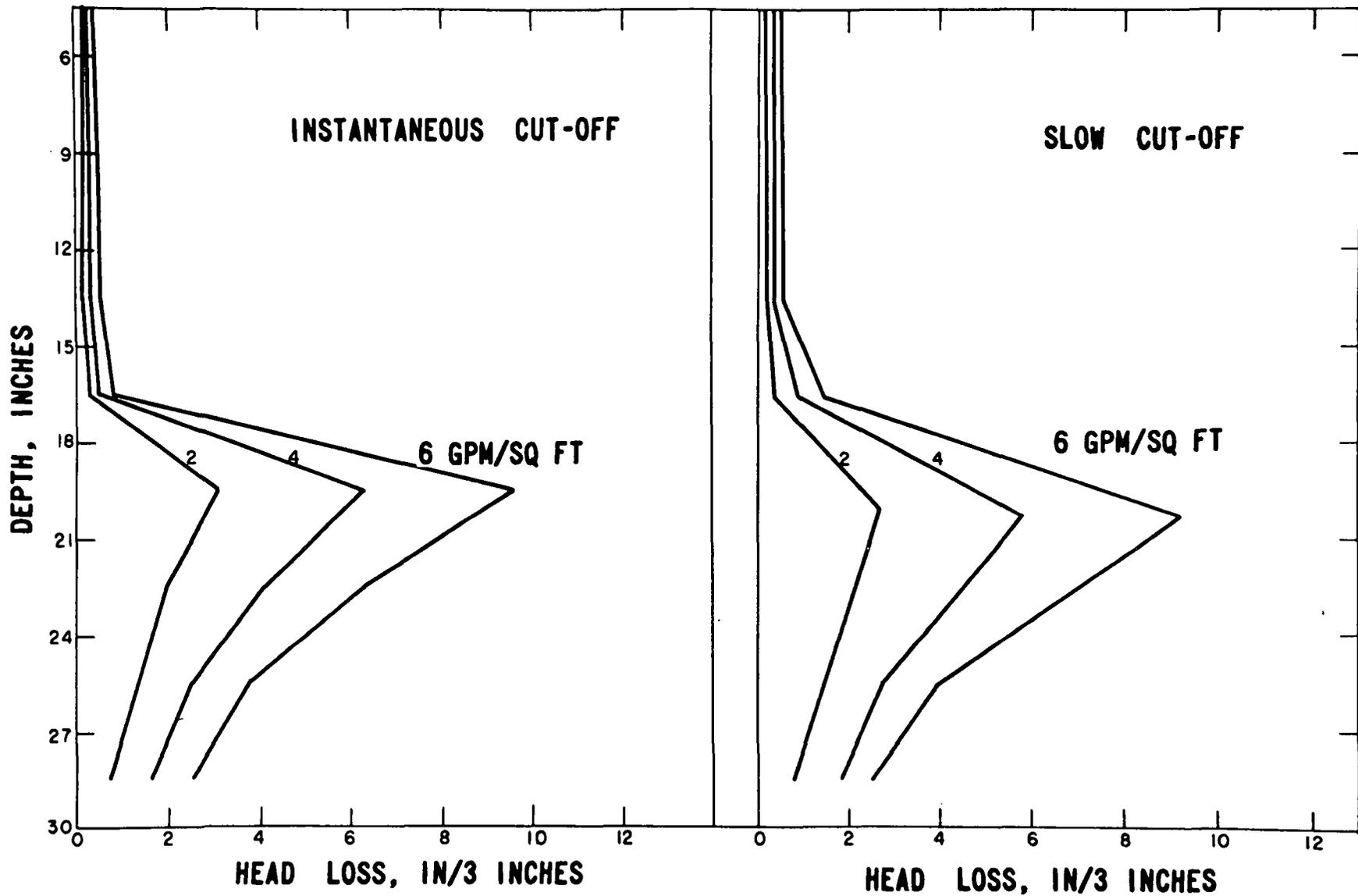
FIGURE 18. Head Loss Gradient, MM-1.
