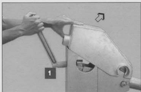
1. Desaperte o parafuso da tampa da cabeça da bomba e retire a tampa
